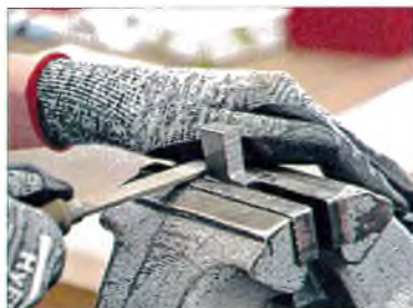
Mira Schröder feilt die Kante eines in einen Schraubstock eingespannten Metallstücks ab.
