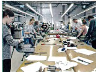
Bei der Anfertigung eines Schließzylinders werden die Metallstücke auch mit Säge und Feile bearbeitet.
