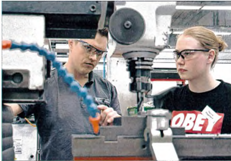
Sebastian Brosch, Ausbilder bei Wago im Bereich Metall, zeigt Schülerin Pauline Plagemann aus Löhne, worauf sie beim Fräsen einer Nut achten muss. Fotos: Kerstin Rickert
